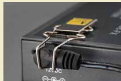
AC/DC ピンジャック(L 字型)+メディアコンバーター
