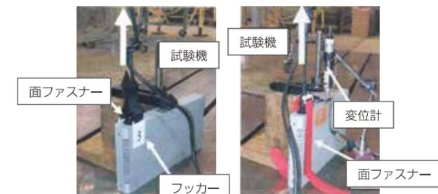
I/Oロックサーバの引張り強度試験
