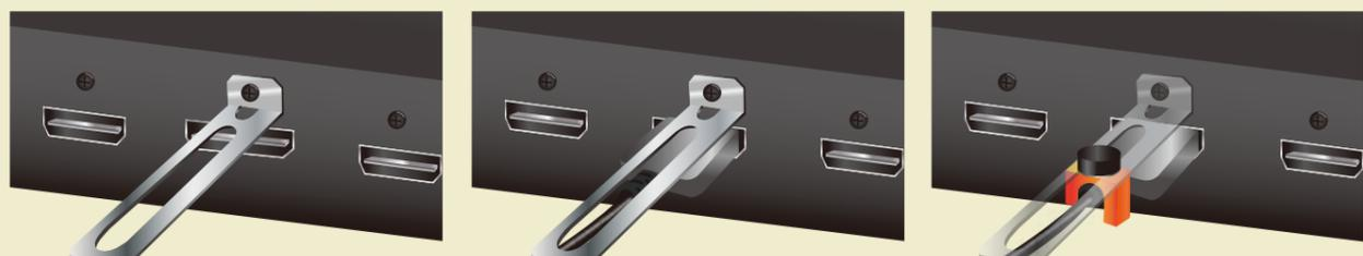
①ポート上部の既存のネジを外してガイドを取り付けます。
