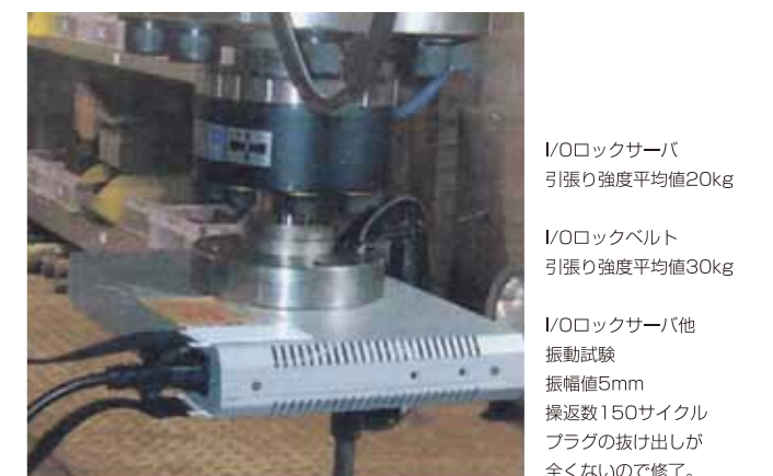
I/Oロックサーバの振動試験
