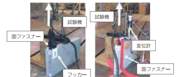
I/Oロックサーバの引張り強度試験
